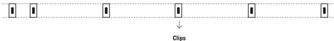
Vous pouvez maintenant cliquer le rail dans les clips. D'abord cliquer l'avant du rail dans le clips, et après l'arrière du rail.
